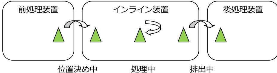
試料の搬送は、試料の位置決め、試料の処理、試料の搬出を行っていない場合に行う事が出来ます。
