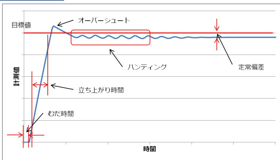
目標制御を開始すると、操作器の操作量が制御対象に伝わるまでの時間（むだ時間）を経過した後、計測値は目標値に近づいていきます。このときの目標値に近づくまでの時間が立ち上がり時間です。計測値が目標値に達したときに、勢いがついていたりすると、オーバーシュートが発生します。その後、ハンティングをしながら、徐々に計測値は目標値付近で安定するようになります。最終的に安定したときの計測値と目標値の差が定常偏差として残ることになります。
